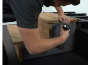
Anlegen und Ausrichten der HPL Seitenverkleidung. Mit der Holzschraube 4x25 mm die Seitenverkleidung an den Fixierungsleisten festschrauben.
