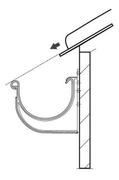
Ein korrekt montiertes System sollte die Rinne vor dem Aufprall der vom Dach abrutschenden Schneemassen schützen. Die obere Kante der Rinnenausbördelung sollte also nicht über die Verlängerung der Dachfläche hinausreichen, was in der Zeichnung ersichtlich ist.
