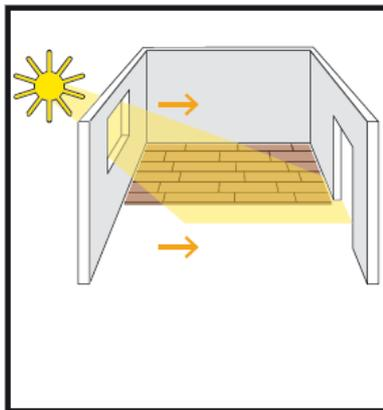
Verlegen Sie die Dielen längs zur Hauptlichtquelle und damit zum einfallenden Licht. Die Verlegung erfolgt von links nach rechts. Die Verlegung der Click-Vinylböden muss schwimmend erfolgen.
