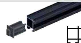
DREAMDECK UK hoch Querverstrebung 10er-Set, Art. 4555, 31 x 34 x 360, mit T-Verbindern Nur für DREAMDECK ALU UK, Art. 2226, 2227, 40 x 40
