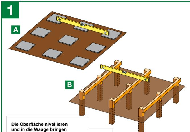
Die Oberfläche nivellieren und in die Waage bringen
