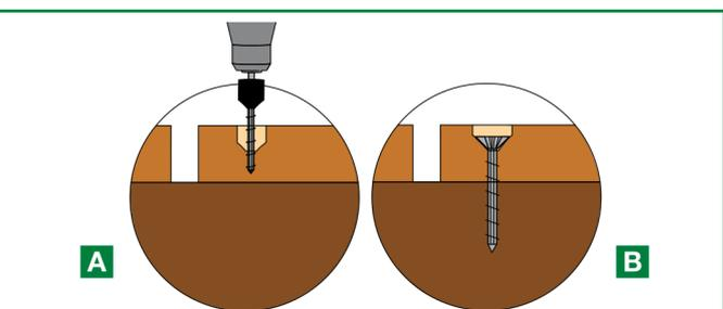
A. Schraubenlöcher mit einem Bohrer (ø 3,5 mm) mit Aufstecksenker bohren. Bohren Sie 2 Löcher pro Befestigungspunkt. Bohrlöcher gleichzeitig mit dem Bohren versenken.
