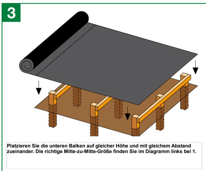
Platzieren Sie die unteren Balken auf gleicher Höhe und mit gleichem Abstand zueinander. Die richtige Mitte-zu-Mitte-Größe finden Sie im Diagramm links bei 1.
