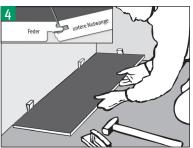
4 Beginnen Sie mit der Verlegung rechts in einer Ecke des Raumes und legen Sie die erste Diele so, dass die Feder zur Wand zeigt (siehe Bild 4). Sägen Sie die Längsfedern aller Dielen der ersten Reihe ab, so dass sie mit der Deckfläche bündig sind. Die folgenden Dielen der Reihe werden stirnseitig passend
