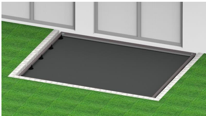
Bild 6. An den 2 äußeren Unterkonstruktionen werden mit Winkeln die vordere und hintere Unterkonstruktion befestigt.
