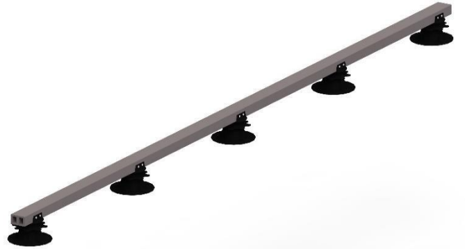
Bild 5. Die Verstellfüße müssen mit einem maximalen Achsabstand von 400 mm an die WPC-Unterkonstruktionen geschraubt werden.
