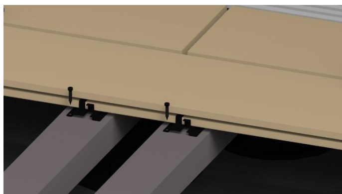
Bild 26. Auch die durchgehenden Dielen sollten mit 2 Clips befestigt werden.
